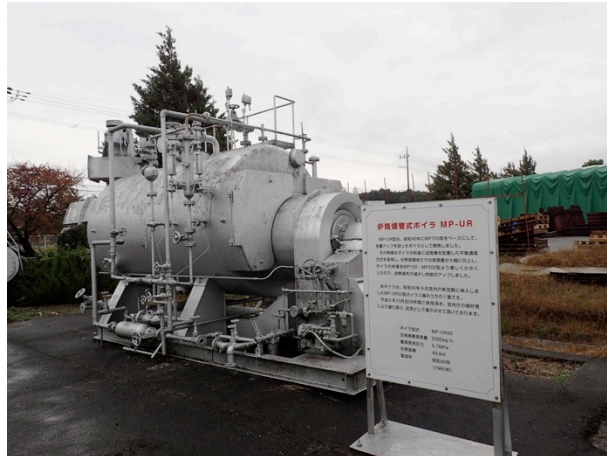
写真3 炉筒煙管式ボイラ(撮影:二階堂, 2023/11/10)
