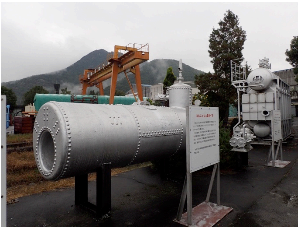
写真1 コルニッシュ型ボイラ(撮影:二階堂, 2023/11/10) 1880年代, 東京電燈を皮切りに各地で電灯会社が設立され, 火力発電を始めた。その頃の国産製品。
