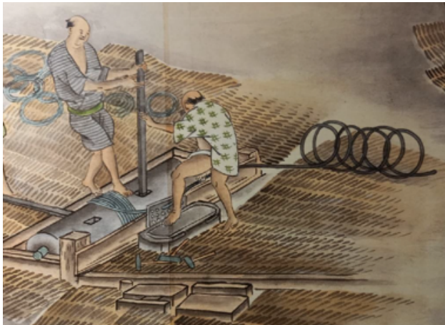
図2 「先大津阿川村山砂鉄取之図」の「ハリ鍍ヲ作ル図」引抜き工程部分（筆者撮影）
