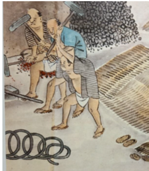
図1 「先大津阿川村山砂鉄取之図」の「ハリ鍍ヲ作ル図」引抜き前工程部分(筆者撮影)
